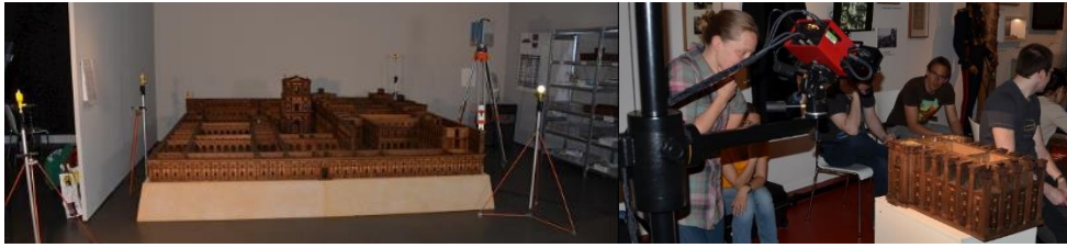
Abb. 5: 3D-Aufnahme des teilweise abgebauten Holzmodells mit dem terrestrischen Laserscanner IMAGER 5010 (links) und des auseinandergebauten Heiligtums (rechts) mit dem Streifenprojektionssystem GOM ATOS.
