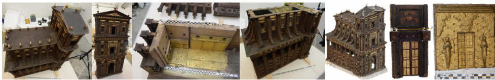
Abb. 6: Fotos der Nikon D800 vom inneren Heiligtum und der Bauteile (vier Fotos von links), die für das SfM-Verfahren verwendet wurden; farbige Punktwolke des inneren Heiligtums und zweier Innentüren (Mitte und rechts), die mit dem SfM-Verfahren aus Fotos der Nikon D800 erstellt wurden (letzten drei Abbildungen von links).
