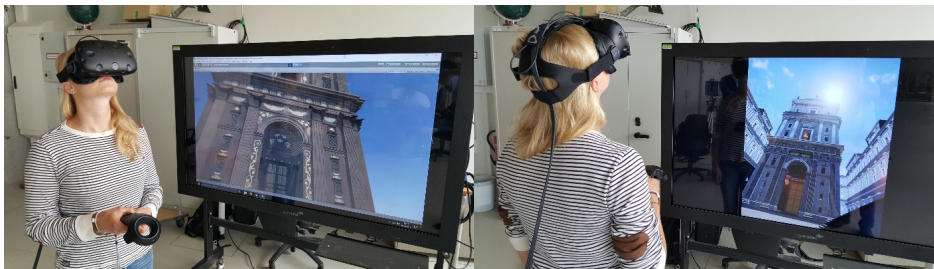
Abb. 12: Das Virtual Reality System HTC Vive in Aktion mit einem Controller zur Interaktion in der Umgebung und zur Darstellung der aktuellen Ansicht im VR-System auf einem Monitor - Das Holzmodell in Unity (links) und das Modell mit Umgebung nach Price (2013) in Unreal (rechts).
