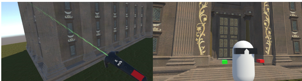
Abb. 11: Navigationssteuerung durch den Controller – im Flugmodus mit 5 m/s um den Tempel (links), Mehrbenutzerfunktion des Virtual Reality Systems HTC Vive (rechts) – ein Avatar mit zwei Controllern (in der linken Hand rot und in der rechten Hand grün) als zusätzlicher Besucher in der VR-Umgebung des Tempels.
