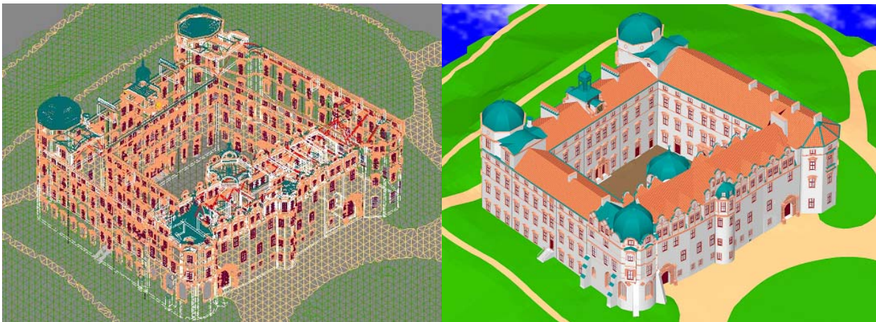
Abb. 5: 3-D-Volumenkörper des Celler Schlosses als Drahtmodell (links) und gerendertes Modell (rechts)
