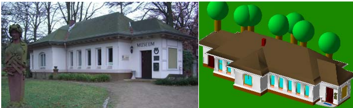
Abb. 7: Manuelle Modellierung eines Gebäudes: links Photo, rechts CAD-Modell vom Friedhofs-Museum in Hamburg-Ohlsdorf
