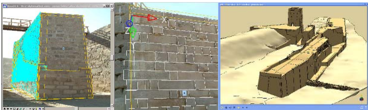
Abb. 10: Kombinierte Darstellung von Punktwolke und Bild (links), detaillierte Auswertung von Einzelsteinen (Mitte) und CAD-Modell (rechts) des Nordbaus der Schleuse des antiken Dammes in Marib/Jemen
