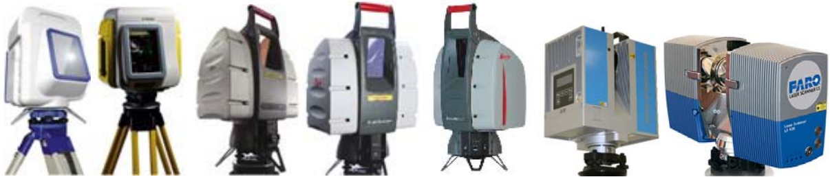
Abb. 3: Eingesetzte terrestrische Laserscanner: Trimble GS101/GX, Leica HDS3000/ScanStation1/ScanStation2, IMAGER 5006 von Zoller + Fröhlich und Faro LS 880HE.
