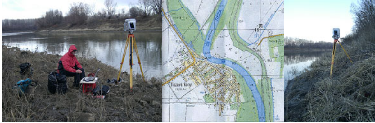
Abb. 6: Mensi GS200 im Einsatz am Fluss Tisza (links), Kartenausschnitt des Projektgebietes bei Tiszavárkony (Mitte) und der Scanner in der rutschigen und lehmigen Uferböschung
