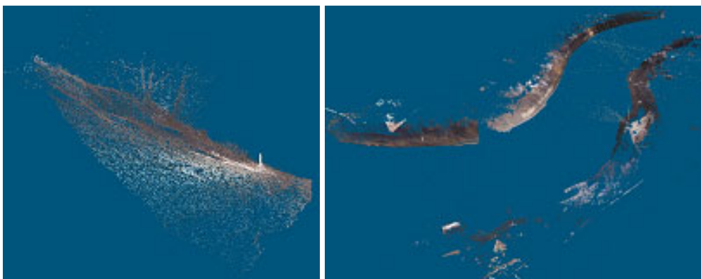
Abb. 7: Punktwolke in Schrägansicht zur Darstellung der Vegetation (links), Darstellung der gesamten Punktwolken der beiden Tisza-Uferböschungen (rechts)
