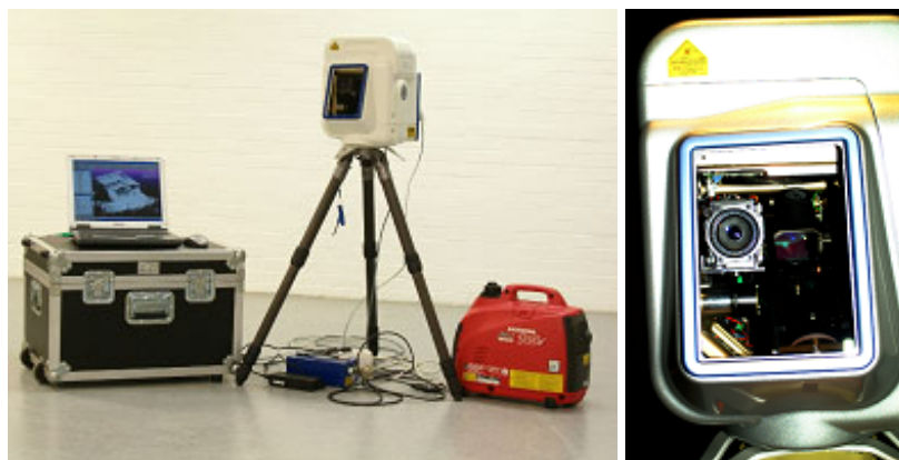
Abb.1: Das 3D-Laserscanning-System Mensi GS100 der HAW Hamburg mit Zubehör (links) und als Innenansicht mit digitaler Kamera und Spiegel (rechts)
