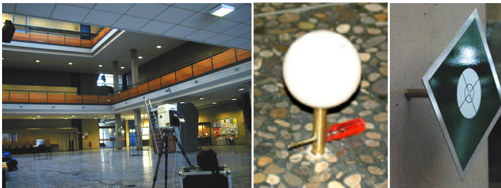
Abb. 3: Scanner im 3D-Testfeld (links), Kugel (Mitte) und Target mit Adapter (rechts)
